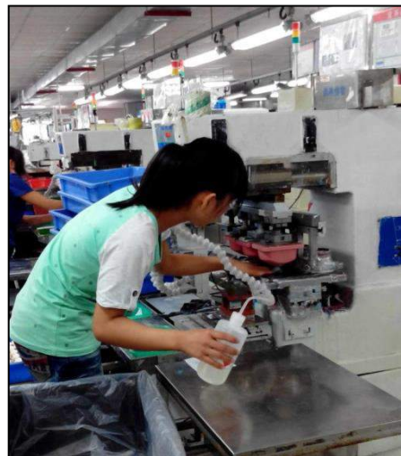
工人没有戴任何保护装备在用天那水 擦拭机器
